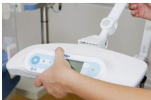
3. Вставьте быстросоединяемый разъем фототерапевтического источника света в гнездо держателя до щелчка.
