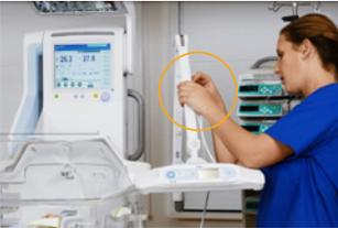
5. Подключите кабель питания к устройству и пропустите его через фиксаторы для кабеля.
